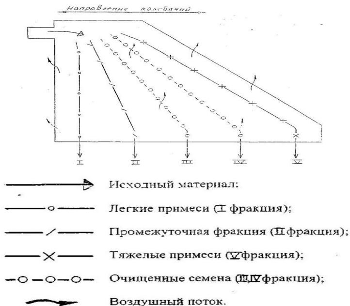
Рисунок. Технологический процесс калибровки семян на пневмо-сортировальном столе ПСС-1,0
