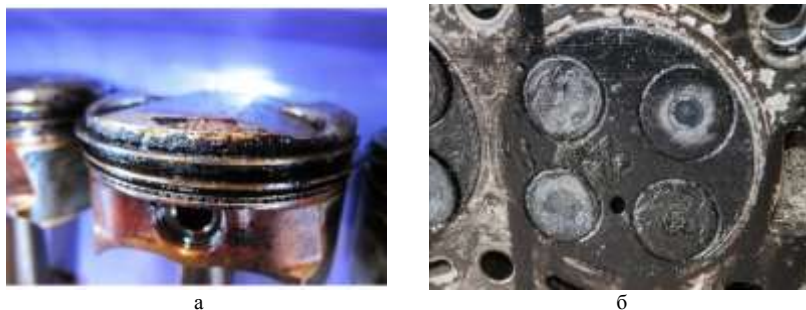
Рис. 1. Сажистые отложения: а) поршень двигателя; б) головка блока цилиндров
