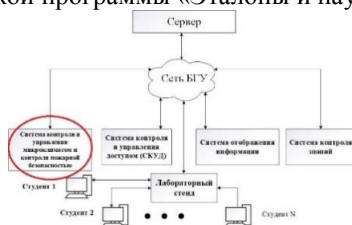
Рисунок. Структурная схема «умной лаборатории»
