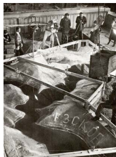
Рис. 3. Модельные исследования волновых режимов в Сарезском озере вследствие обвалов и оползней
