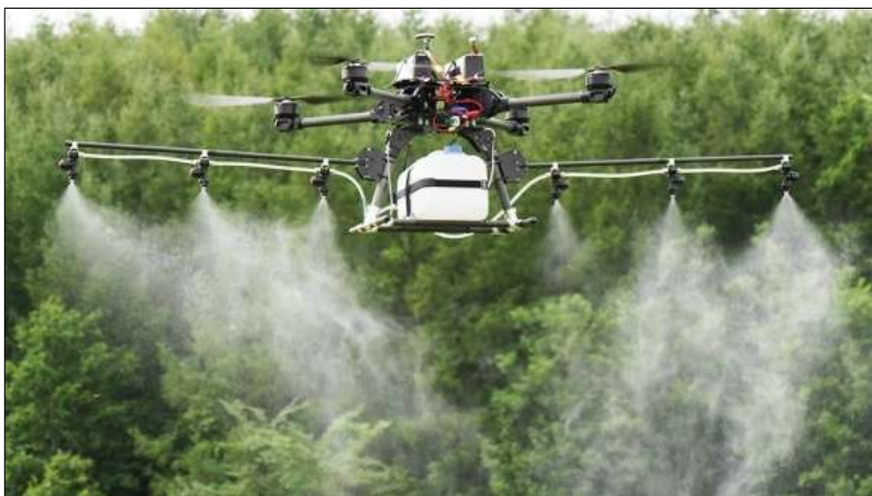
Рисунок 1 – Проведение ультрамалообъёмного опрыскивания с помощью беспилотного летательного аппарата
