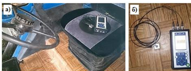
Рис. 2. Места установки датчика АР2038Р-10 в кабине колесного трактора: а) подушка сиденья; б) опорная поверхность для ног (пол кабины)
