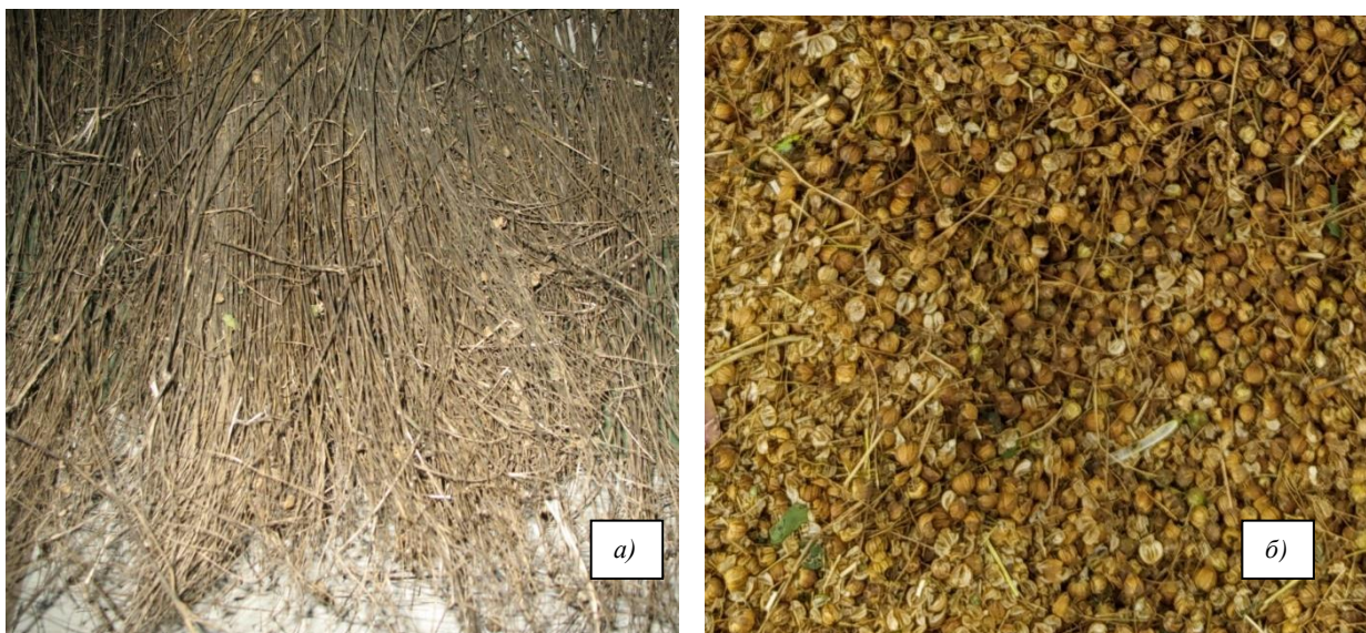
Рис. 3. Результаты применение обмолачивающего устройства с эластичным рабочим органом: а) – вид ленты льна после обмолота; б) – ворох льна полученный после обмолота
