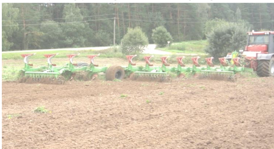
Рис. 2. Плуг 12-корпусный оборотный ПО-(8+4)-40 в работе
