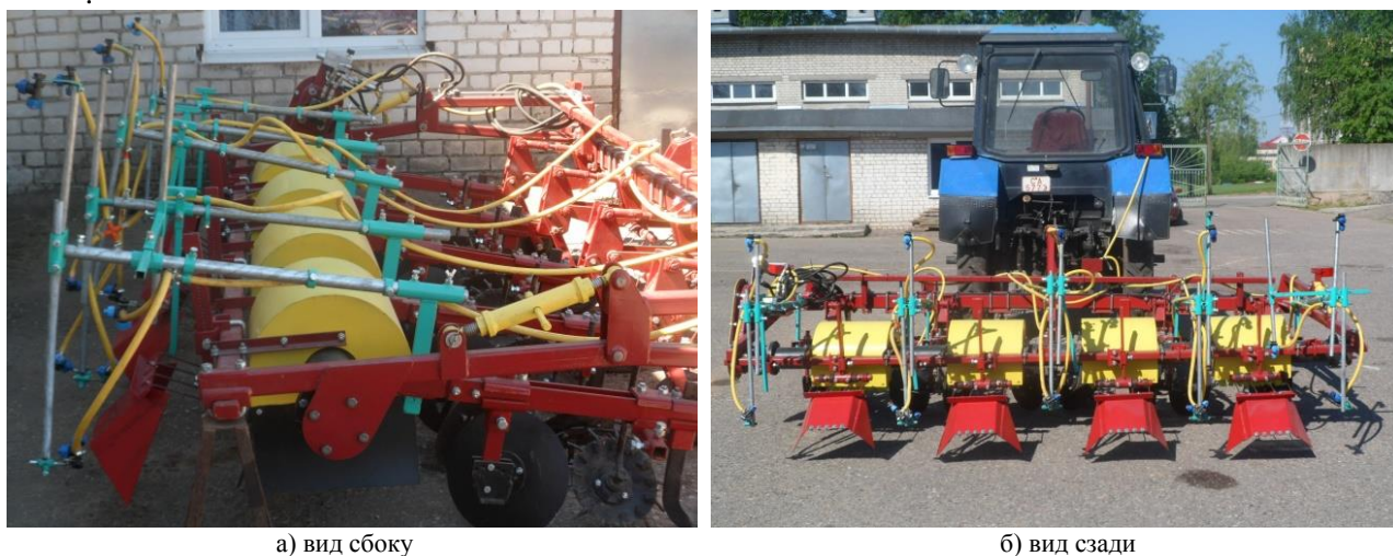
Рис. 2 Опрыскиватель телескопический комбинированный в составе агрегата для междурядной обработки АУ-М2
