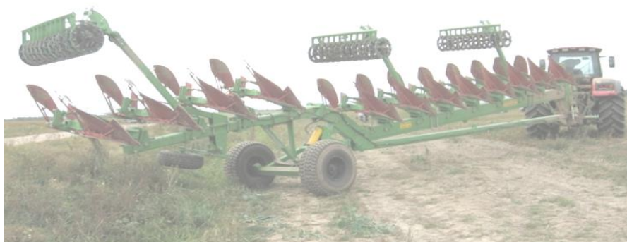
Рис. 1. Плуг 12-корпусный оборотный ПО-(8+4)-40 в транспортном положении
