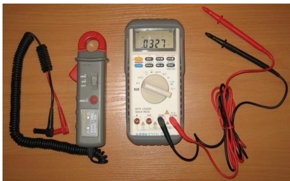
Рис. 4. Общий вид цифрового мультиметра APPA – 109N с токоизмерительными клещами
