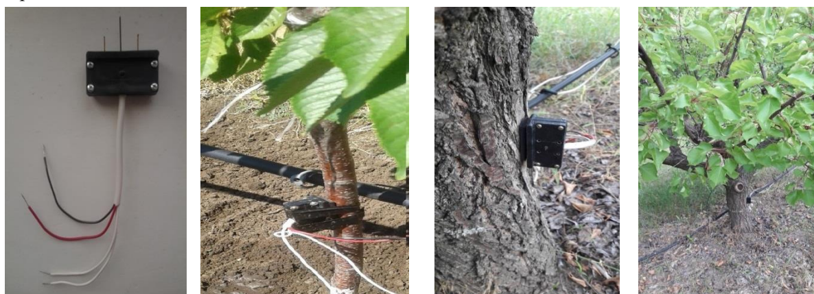
Рис. 1. Общий вид датчиков измерения индекса ксилемного потока в стволе черешни и абрикоса: а) датчик; б) датчики в стволах деревьев
