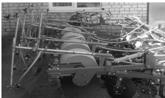
Рис. 5. Опрыскиватель с телескопическими секциями в составе агрегата для междурядной обработки АУ-М2 (вид сбоку)
