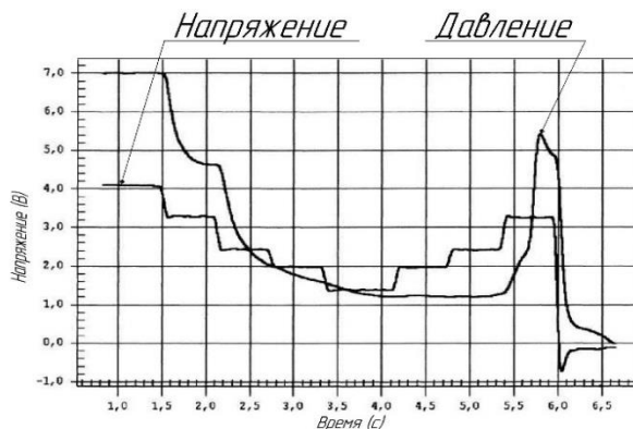
Рис. 3. График зависимости напряжения управления и давления во фрикционной муфте от времени
