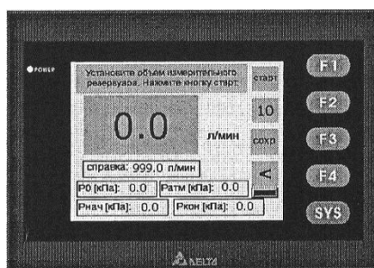
Рис. 3. Представление информации на дисплее при измерении расхода воздуха доильным аппаратом
